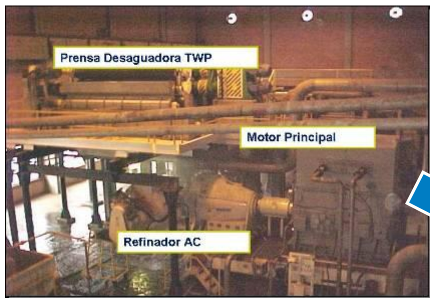
Layout Sistema de Refinação de Alta Consistência
