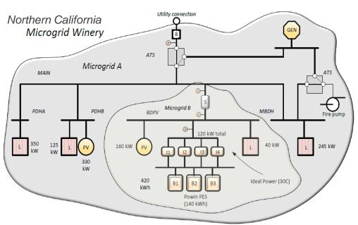
120kW / 420kWh Battery 600kW Solar PV 2 Microgrids
