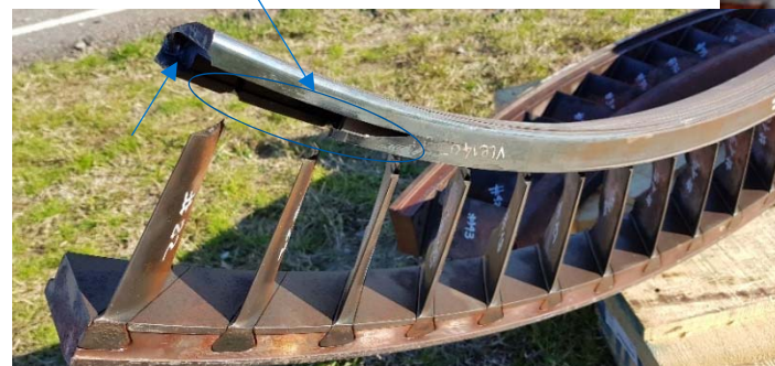
Parte faltante (desprendida), De diafragma
